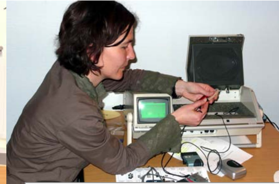
Individuelle Einstellung der FM-Empfänger mit Hilfe der Messbox
